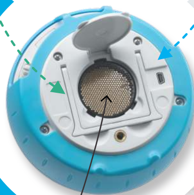
Czujnik odległości umieszczony z tyłu dysku
